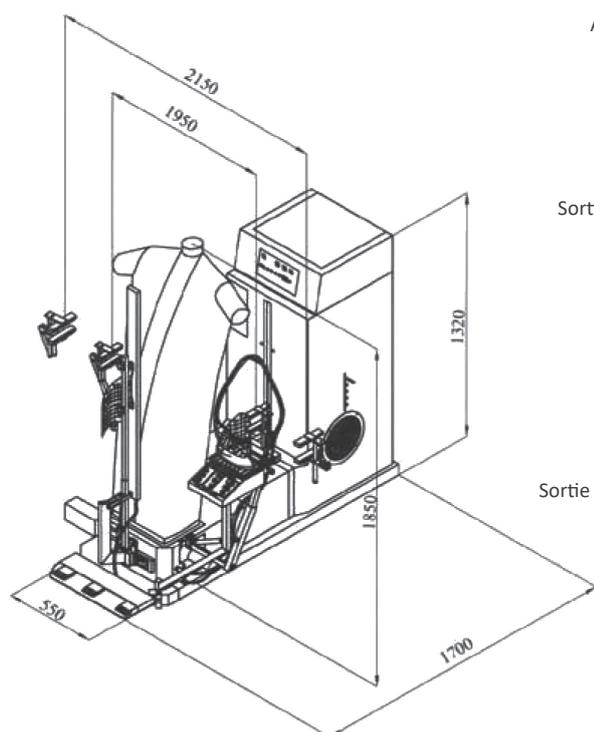
Air comprimé 1/4": Pression conseillée min. 4 Bar - max. 7 Bar
